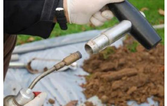
Ponga el frasco listo, precargado con 25 gramos de metanol o tiosulfato de sodio (para bajas concentraciones). Ver US-EPA 5035A-2002 o consulte el laboratorio.
