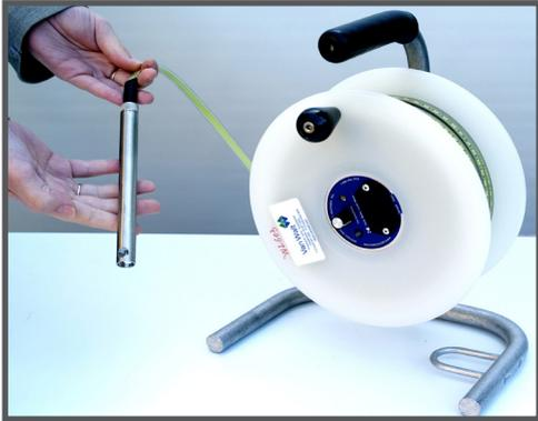
La **Sonda de Interfase de Aceite** utiliza una sonda de 16 mm para detectar hidrocarburos a partir de 1,52 mm en pozos a partir de 19 mm de diámetro
