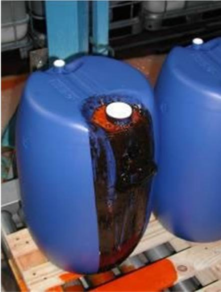
Cuando sus depósitos y cubas recogen diversas sustancias químicas, almacenan una mezcla que puede producir una reacción peligrosa (explosión, liberación de gases nocivos, etc.)
