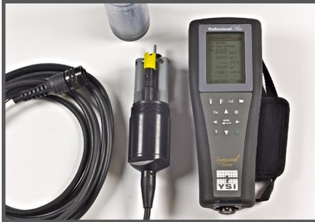
El **YSI Pro Plus** es un medidor multiparamétrico robusto, inteligente y portátil para la medida de pH, conductividad eléctrica, temperatura, Oxígeno disuelto y Redox
