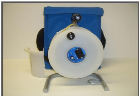
El **Medidor de Nivel de Agua** utiliza una sonda de 16 mm para medir la profundidad de pozos con una precisión de 3 mm.
