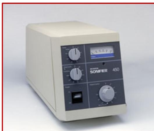
Cada modelo consiste en una fuente de potencia, un convertidor y una sonda mecánica o resonador. La fuente de potencia cambia la potencia eléctrica estándar en energía mecánica de alta frecuencia, que se aplica al resonador, donde se amplifica para su uso (a menudo con accesorios especiales).
